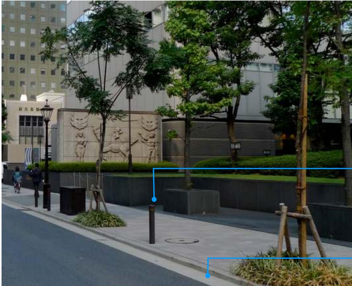
車両の乗り上げを防ぐため、ボラードを設置するのが一般的である
