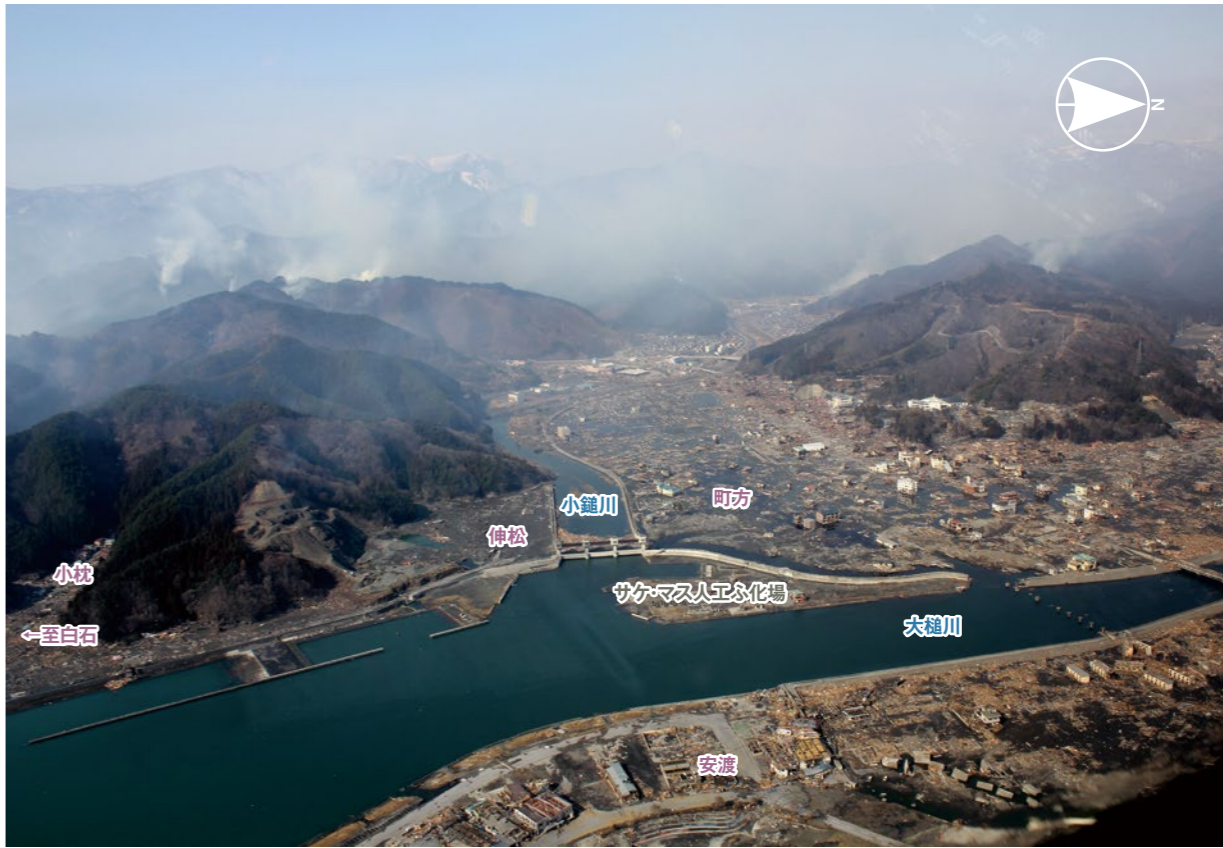
地形的な条件から小枕には海からの高い津波が、伸松には河川津波が押し寄せた(2011年3月14日撮影) ※写真中の情報は震災当時。方位は目安
