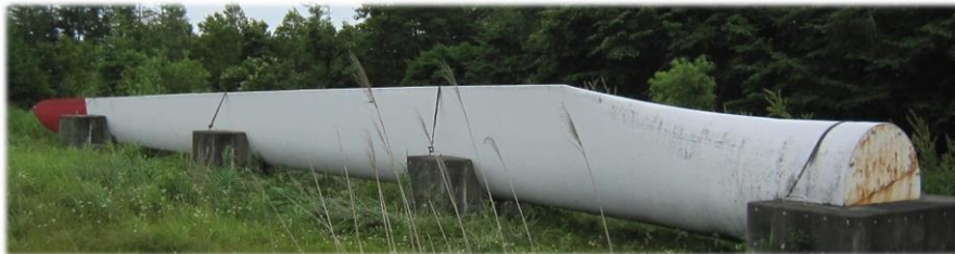
新山高原に展示している風力発電用風車ブレード
